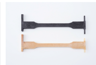
▲ ダンベル試験片 JIS K7139 A1 t4
