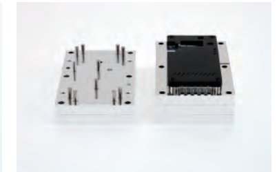
▲ 押出プレートによる成形品の取り外し
