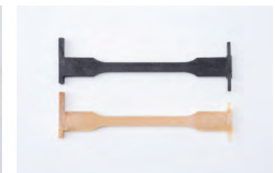
▲ ダンベル試験片 JIS K7139 A1 t4
