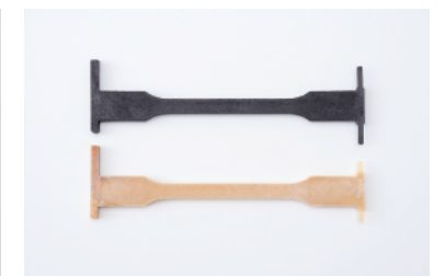
▲ ダンベル試験片 JIS K7139 A1 t4
